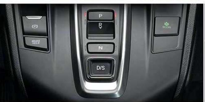
9-SPEED AUTOMATIC WITH ELECTRONIC GEAR SELECTOR3
